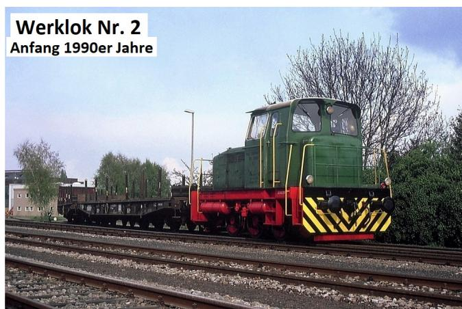
Nach dem Dampfbetrieb verrichteten Diesellokomotiven die täglich anfallenden Rangierarbeiten. Lok Nr. 2 war eine von der Firma Krauss-Maffei 1966 gebaute Maschine (Typ ML 500 / 500 PS), die bis etwa 2000 im Einsatz war.
