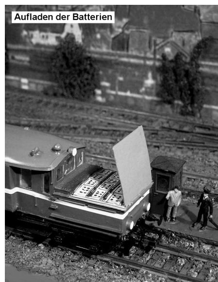
Die Batterien waren beidseitig in Vorbauten untergebracht. Dadurch wurden Belästigungen durch gelegentlich austretende Säuredämpfe für die Reisenden im Fahrgastraum vermieden. Das Aufladen der Batterien wurde immer mit geöffneten Hauben durchgeführt.
