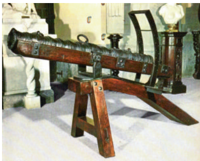
Eine „Feldschlange" aus dem 15. Jahrhundert (Hinterlader). Solche Geschütze gab es im 15. und 16. Jahrhundert auch auf „Zweiradlafetten" montiert, sowie auch als „Blockgeschütze" auf Schiffen.
